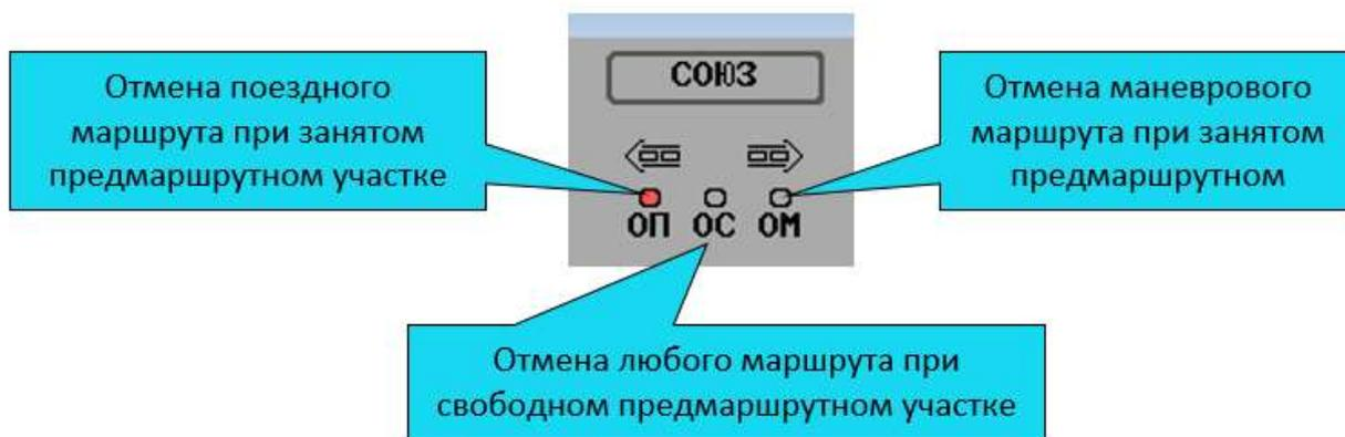
Рис. 7. Фрагмент пульт-табло станции при отмене поездного маршрута.
